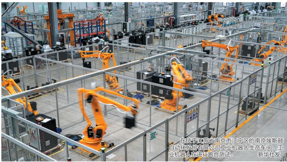
在位于江苏省南京市江宁区的南京埃斯顿自动化股份有限公司工业机器人生产车间,工业机器人正在进行跑合测试。
