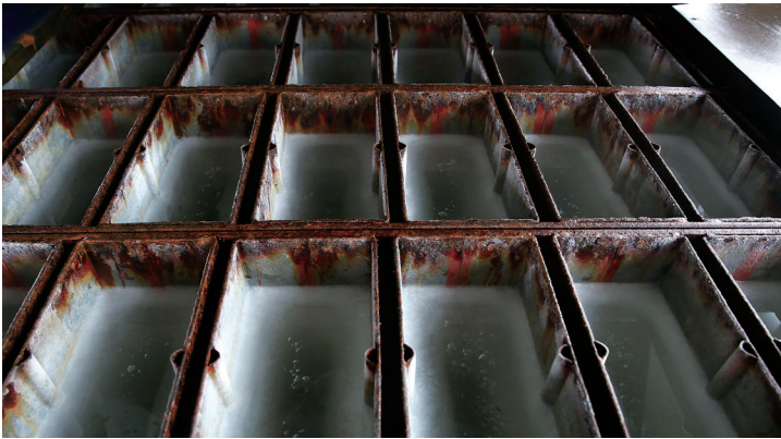
制冰池里,一个个冰模子整齐排列,需要经过30多个小时才能形成实心冰块。
