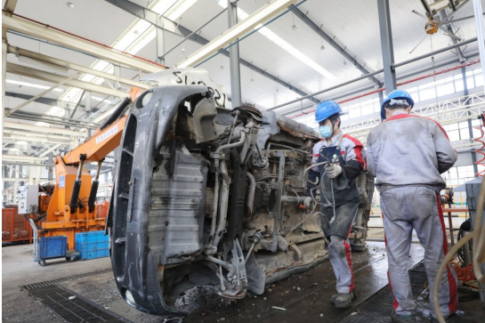
车辆内饰拆解后,工人来到底盘拆解工位。
