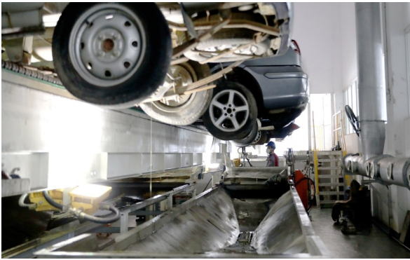
车辆拆解前,工人放掉车辆的汽油、防冻液、机油等进行统一回收。
