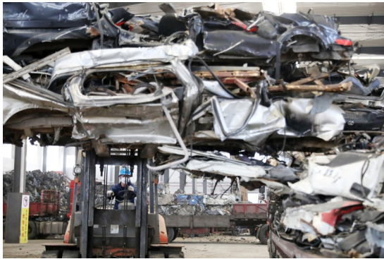
破碎后的车辆,被送往破碎中心,粉碎分选后成为一级废钢。
