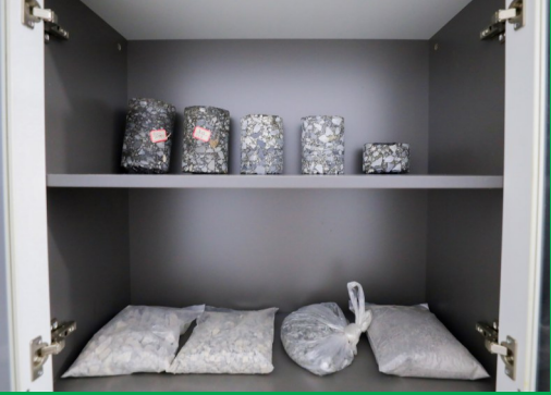
吴兴人才产业集团办公室里还存放着湖织大道改造提升工程建设中的原材料封样和沥青芯样。
