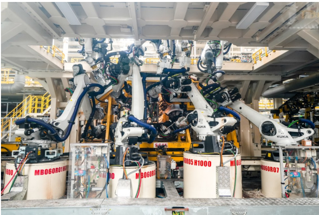
焊装车间,16只机械臂同时运作,对车辆完成焊接工作
