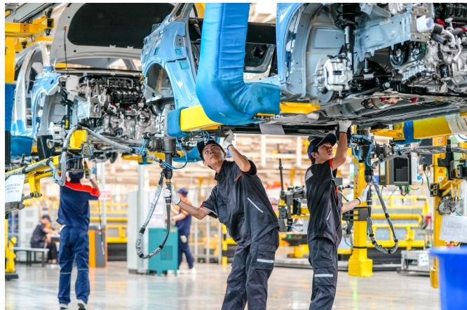
总装车间,工人们在装配调试底盘
