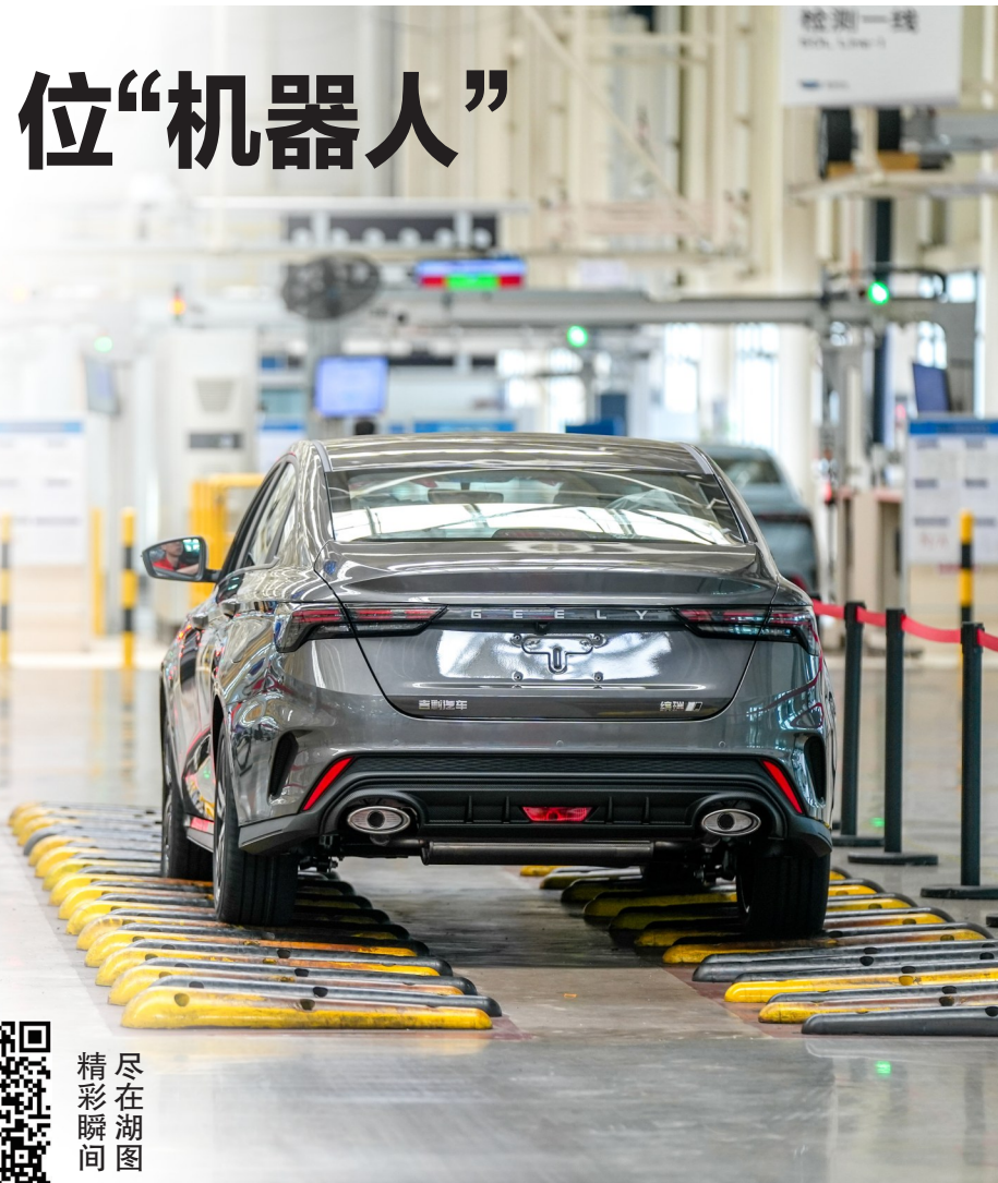
刚下线的新车在接受颠簸路段测试
