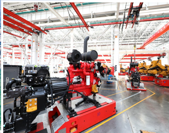
智能机器人将装配好的发动机送往总装车间
