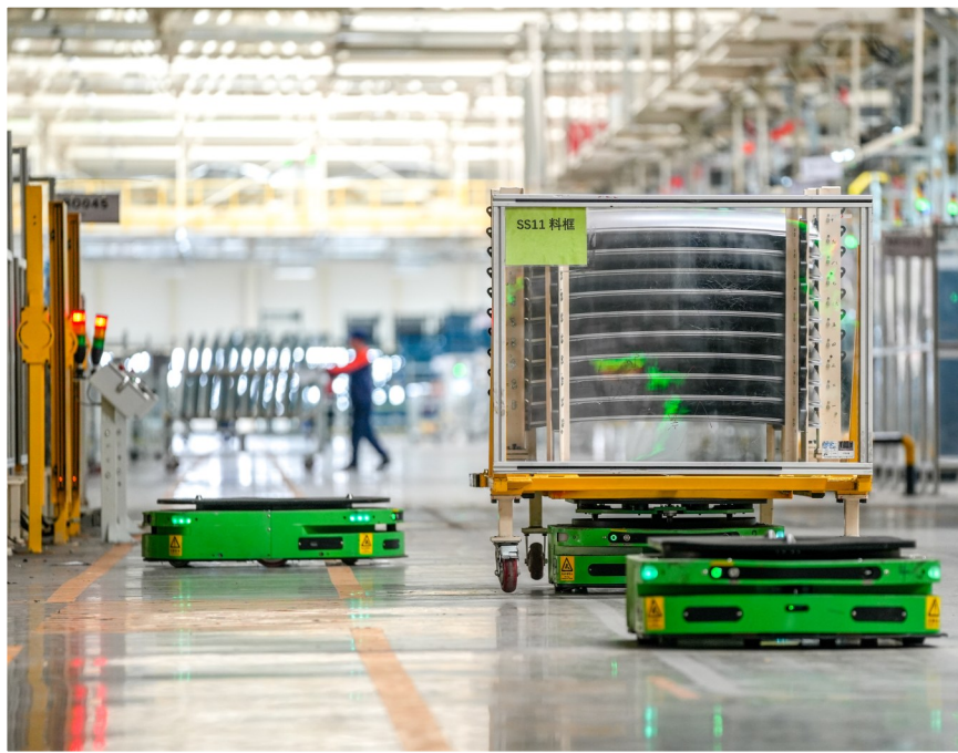
焊装车间,自动运输机器人将车顶盖板运送至生产线
