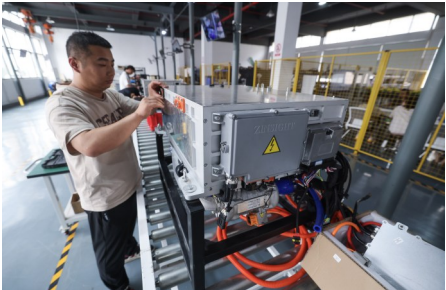
在位于金华市金东区的群星科技（浙江）有限公司车间，工作人员在装配应用于汽车、无人机等领域的氢燃料电池。 (徐昱 摄 新华社发)
