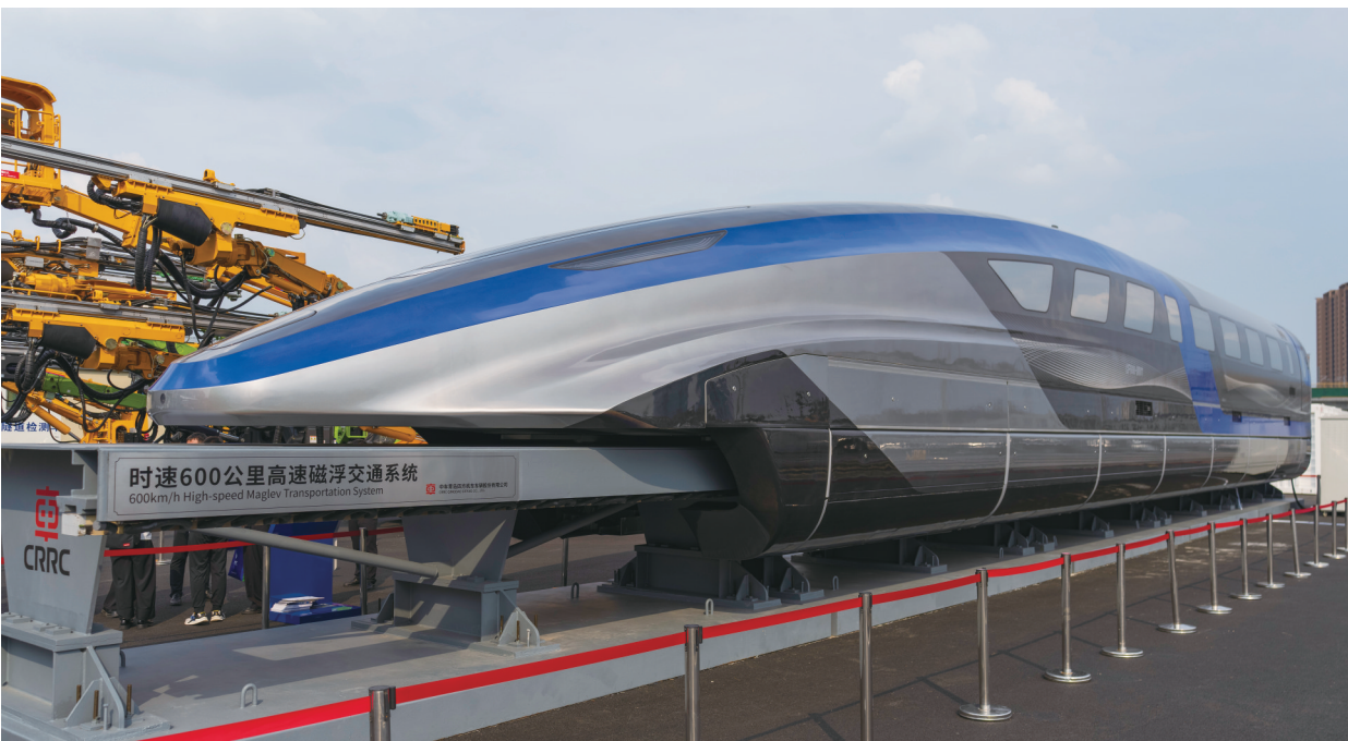
这是7月9日在国家铁道试验中心展区拍摄的时速600公里高速磁浮交通系统。
