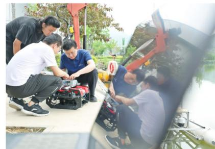
李冠男(右)和团队成员调试水下机器人声学定位系统。
